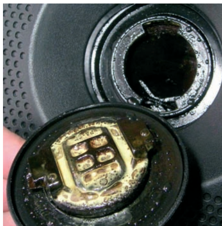
Obr. 1. Nemrznoucí kapalina v oleji.
