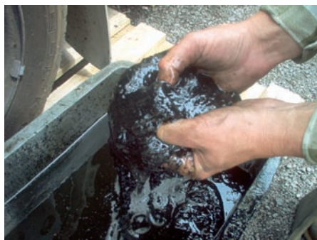
Obr. 2. Toto udělá glykol s motorovým olejem.
