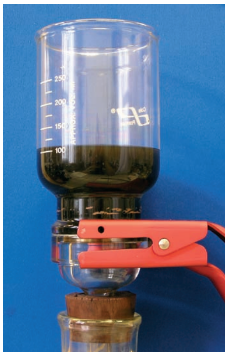
Filtrační zařízení pro membránovou filtraci.
